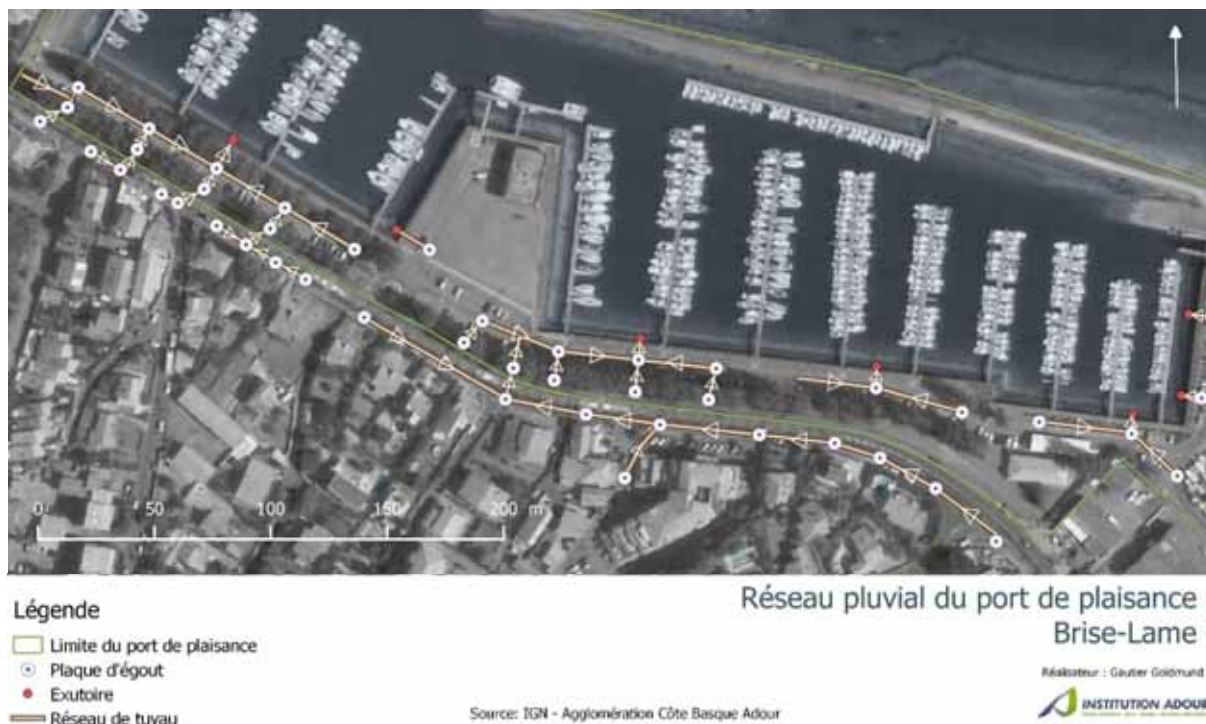
Figure 28 : Cartographie du réseau pluvial du port de plaisance du Brise-Lame
