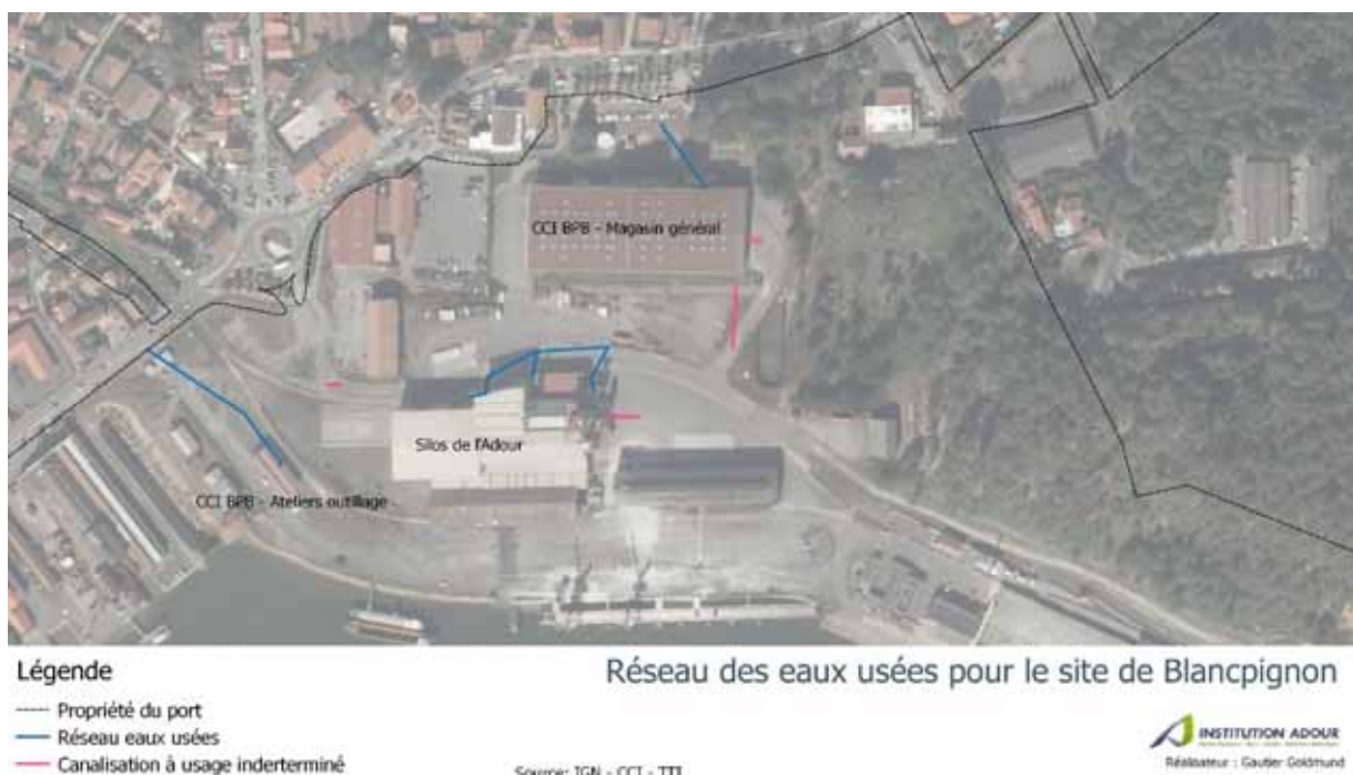
Figure 24 : Cartographie du réseau des eaux usées sur le site de Blancpignon ; source : CCI BPB – TTI Production
