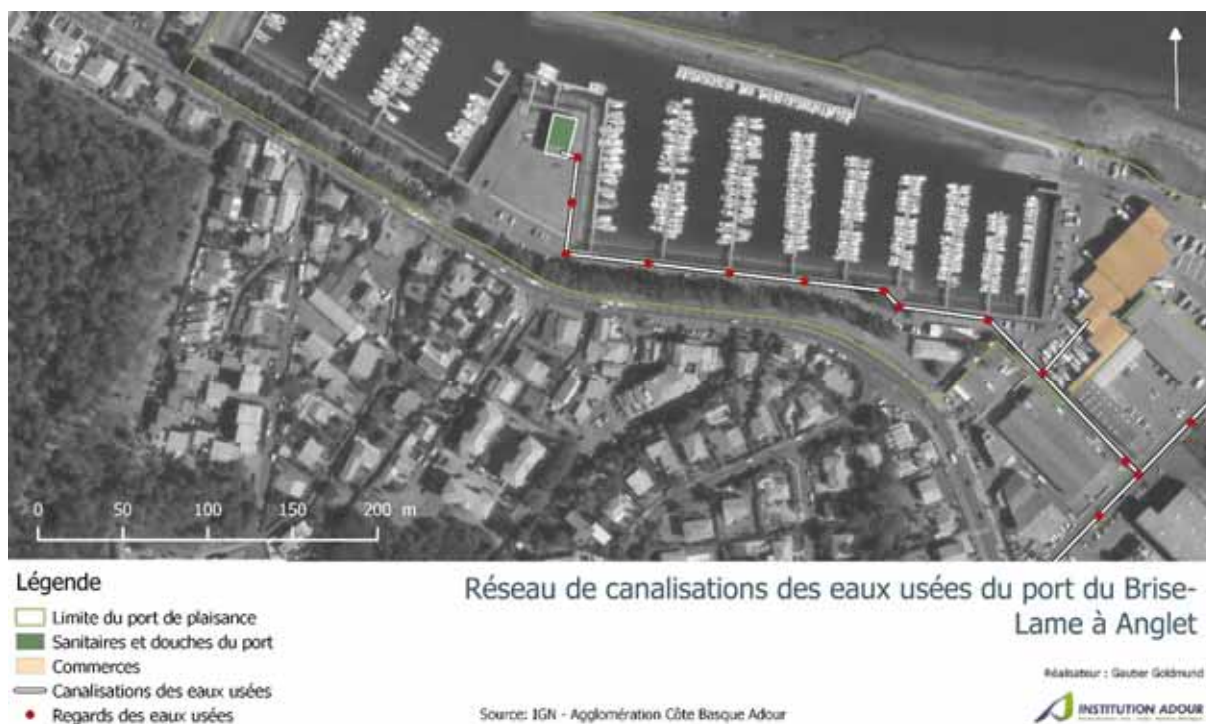
Figure 27 : Cartographie du réseau de canalisations des eaux usées du port du Brise-Lame à Anglet
