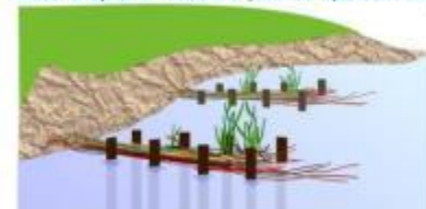
Schéma de principe de la pose d'épi avec fascine
