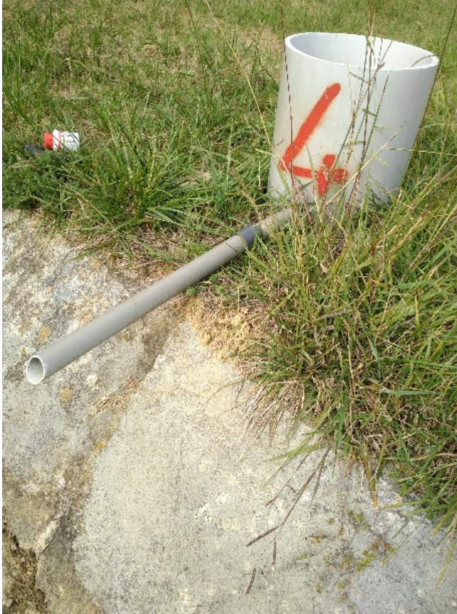
Figure 22 : piézomètre 4 après réparation
