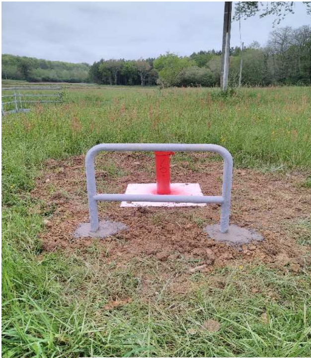
Figure 19 : Piézomètres après réparations
