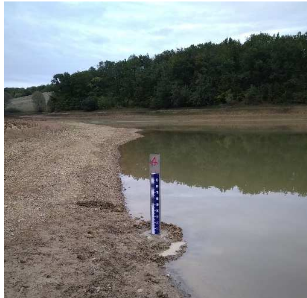
Figure 1 : Echelles limnimétriques après remplacement
