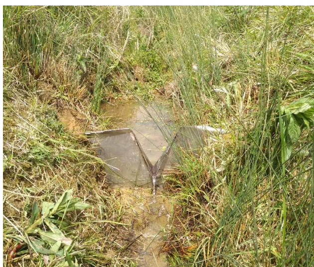
Figure 14 : Installation d'un seuil de mesure de débit de résurgence pour le barrage de Tillac
