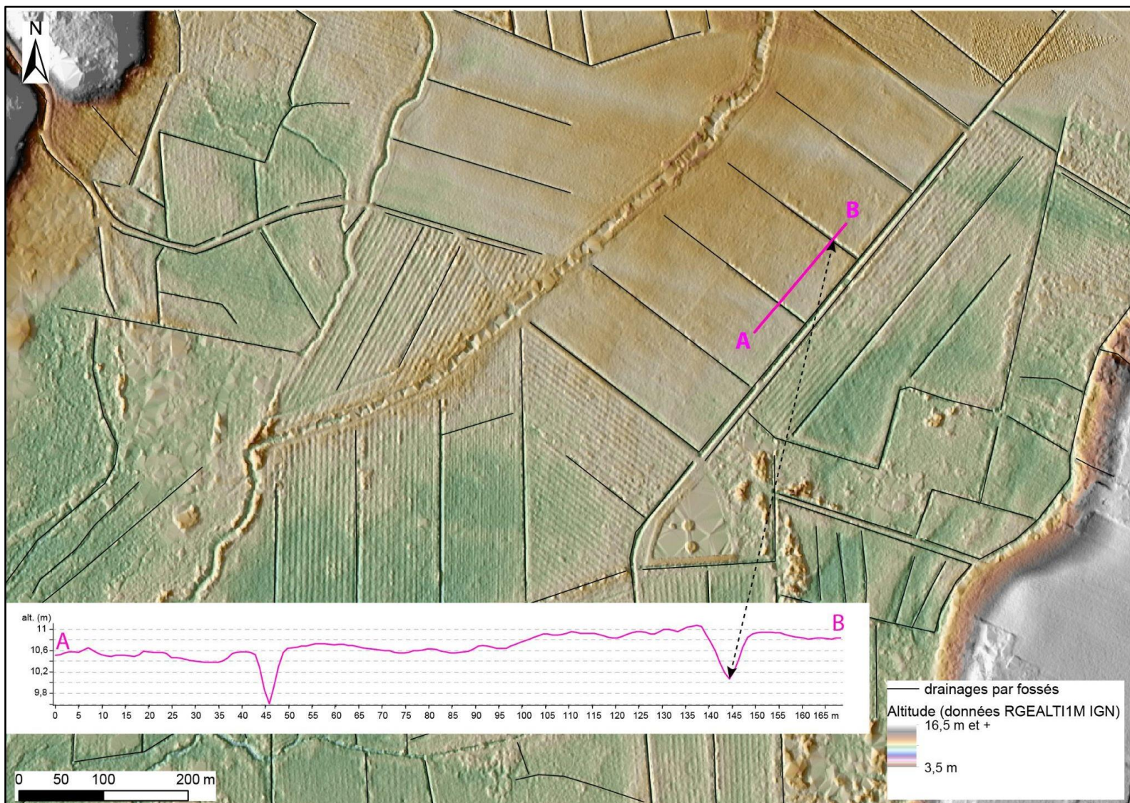
Figure 4.11 : Exemple de fossés de drainage avec un profil incisé en V sur la commune de Bégaar. Le dégradé de couleurs symbolise les variations altimétriques du relief d'après les valeurs du RGEALTI1M de l'IGN.
